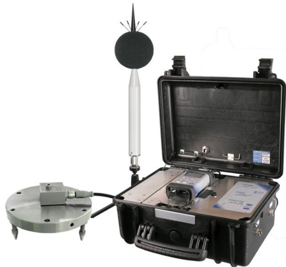
FIGURA 2 - ESEMPIO DI STAZIONE INTEGRATA RUMORE E VIBRAZIONI IN REMOTO CON CONTROLLO REMOTO
