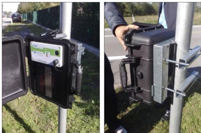
Figura 24 – RADAR SDR-Easydata – Esempio di installazione
